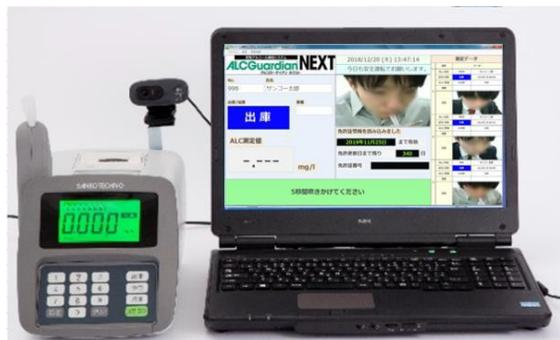
飲酒により呼気中に含まれるアルコール濃度を測定し、同時に「出庫/帰庫」「測定者名」「測定日時」「測定結果」「画像」を自動的にデータ保存出来る呼気アルコール検知システムです。蓄積データは帳票として印刷することも出来ます。
